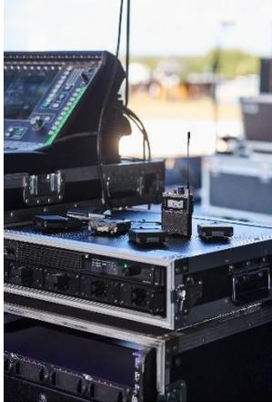
Mit Spectera können backstage große Racks mit IEM-Sendern und Mikrofonempfängern durch eine einzige smarte Base Station ersetzt werden
